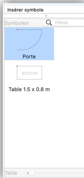
Le symbole s'affiche sur fond bleu. Sélectionnez le mode de capture *Automatique* et cliquez la jonction entre le trait d'aide et la cloison intérieure horizontale. La porte est insérée.
